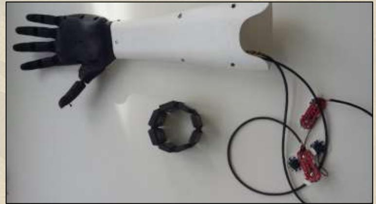
Az összeszerelt prototípus, Myo Armband-al
